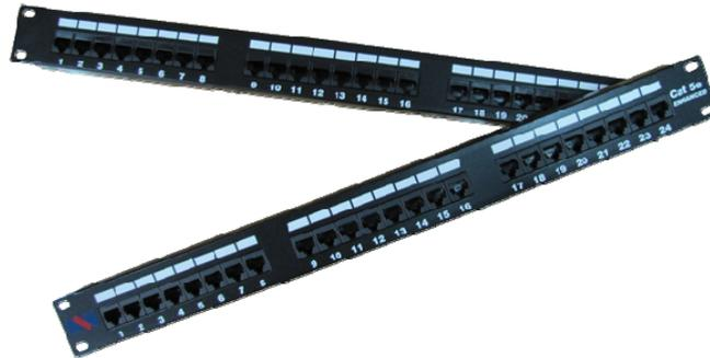
1U 19"標準結構，可固定於 19"標準機櫃內，提供 24PORT，內為三組 8 PORT 模組式之資訊插座，模組使用密封設計，避免粉塵或金屬廢料附著於電路板上，造成電路板短路。採 110/Krone 兩用型壓接端子，可適用線徑範圍：24~26 AWG solid wire。通用標示依現場 T568A 或 T568B 打線方式，面板前面有標示區以利標示。符合 EIA-RS310 規範。
