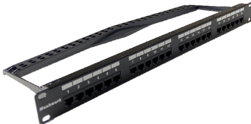
適合 19" 機架機櫃，符合 EIA-RS310-D 規範。1U 24PORT 內為 4 組 6 PORT 模組式，採無螺絲固定六孔模組設計，前面空白標示板方便填寫、標示文字。後方可加裝理線架，搭配束帶專用型以固定纜線避免纜線過度曲折。依需求不同另有 48PORT 供選擇。
